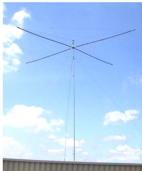
"Спайдер" на 10-метровой алюминиевой выдвижной мачте
