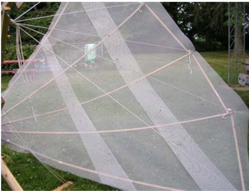
Рисунок 9 - Алюминиевая сетка привязана к спицам проводом.
