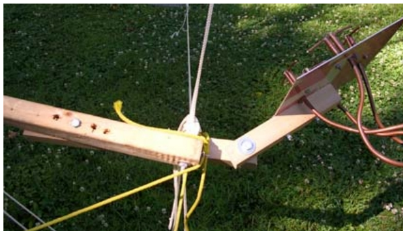
Рисунок 8 - Облучатель смонтирован с использованием нескольких опор для оптимального позиционирования Fig. 8 - The feed is mounted using several supports to allow optimum positioning
