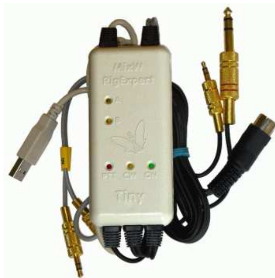
Рис.9.2. Интерфейс «RigExpert Tiny»
