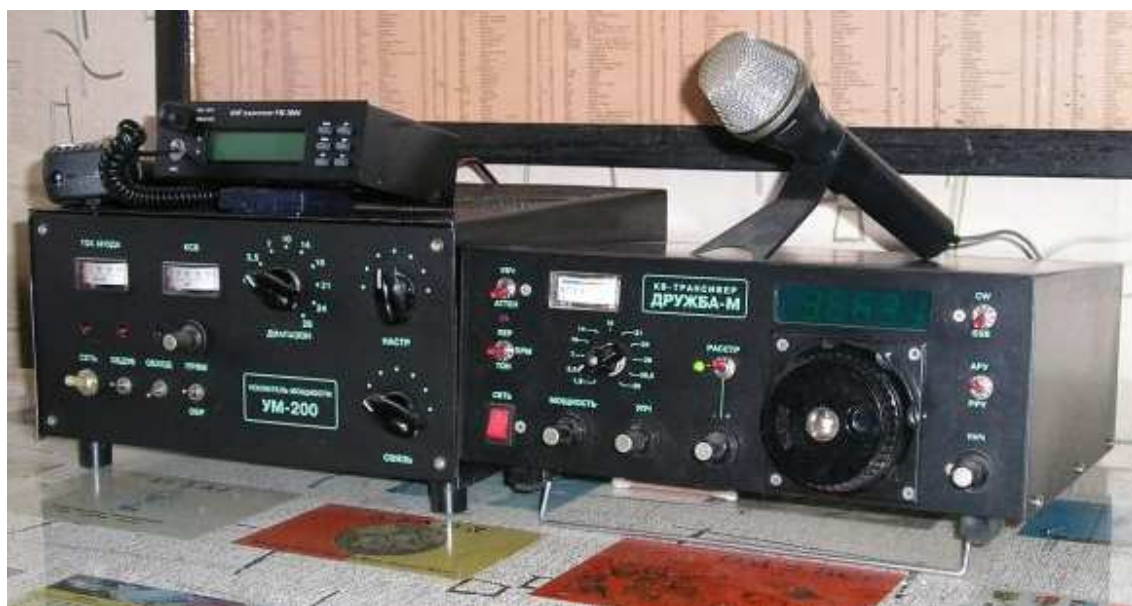
Рис.2.6. Трансивер «Дружба-М» и усилитель мощности «УМ-200»
