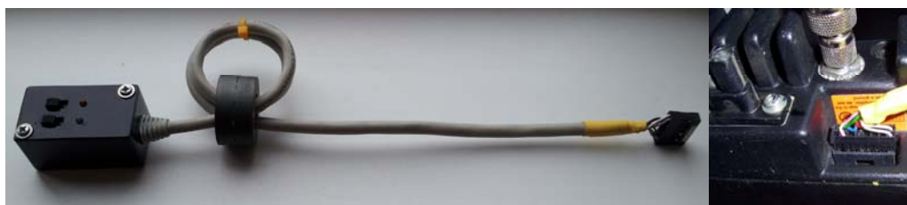
Эхо-репитер, как отдельное устройство. Светодиоды индицируют включение устройства (зелёный) и включение передачи (красный).
