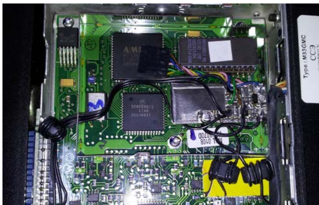
Пример размещения эхо-репитера внутри трансивера Motorola GM-300
