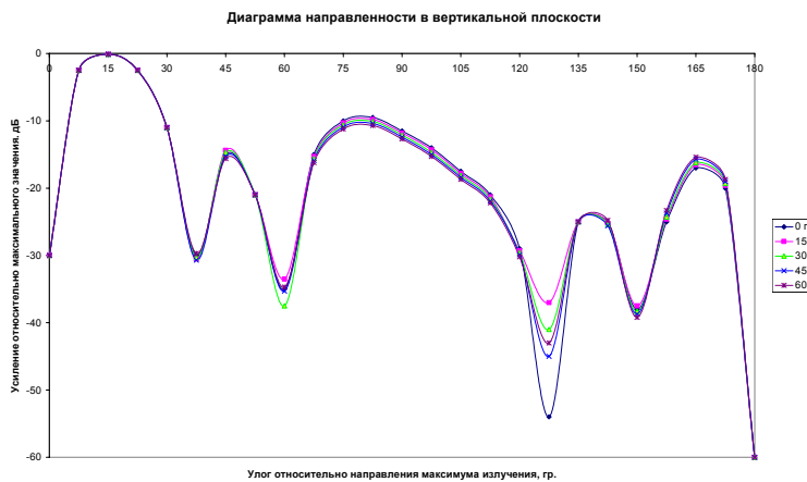
Рис. 2б – ДН в вертикальной плоскости средней антенны стэка (высота 22 м).
