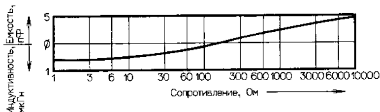
Рис. 3.49. Реактивные составляющие сопротивления для пленочных резисторов с номиналами \leq 10 \text{ кОм}/\leq 1 \text{ Вт} (качественная зависимость). Для ВЧ-диапазона значения 50–250 Ом оптимальные.
