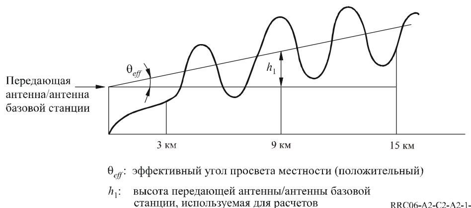
РИСУНОК А.2.1-1 Эффективный угол просвета для h_1 < 0
